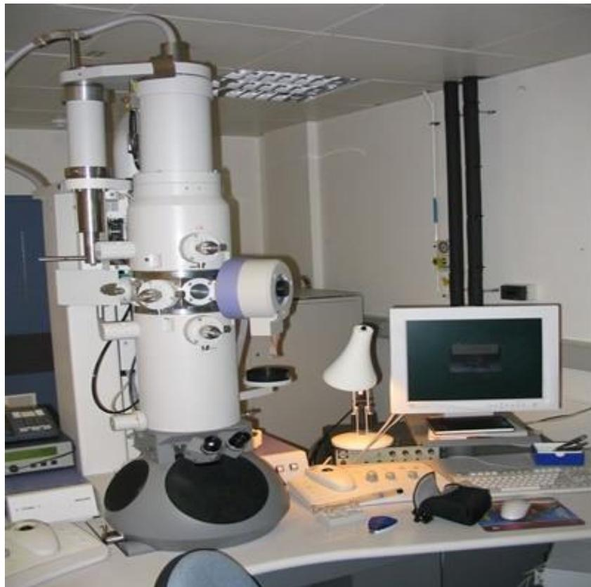
Fotografia de um microscópio eletrônico dentro de um laboratório. O microscópio (estrutura maior à esquerda) é acoplado a um monitor onde são visualizadas as imagens e onde são retiradas as fotomicrografias. Fonte: David J Morgan/Creative Commons (CC BY-SA 2.0).
